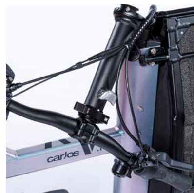
Stuurpen inklapbaar en in hoogte verstelbaar
